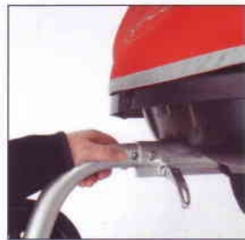
Deichsel und Buggyrad lassen sich mittels einer Knopffeder einfach montieren und mit Schnellspanner festklemmen.
