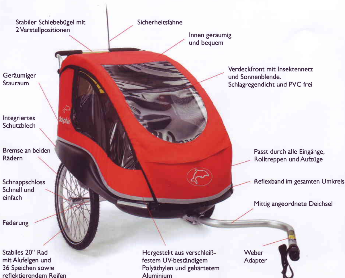
Deichsel und Buggyrad lassen sich mittels einer Knopffeder einfach montieren und mit Schnellspanner festklemmen.
